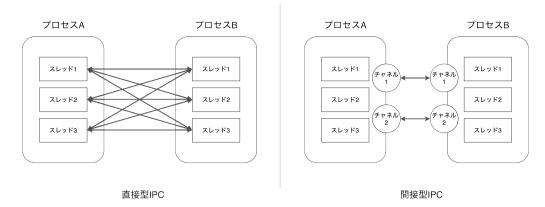
直接型・間接型 IPC の概要。間接型 IPC では必ずチャネルを通して通信し、直接型 IPC では通信相手をスレッド ID で指定する。直接型 IPC では通信先を誰でも指定できるため、通信相手のアクセス制御を考慮する必要がある。
